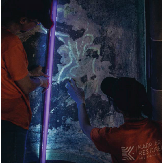
Рис. 3–4. Дослідження стінопису за допомоги ультрафіолетовій області спектра
