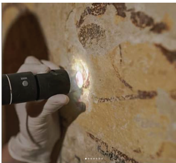
Рис. 1–2. Процес дослідження за допомогою цифрового мікроскопа
